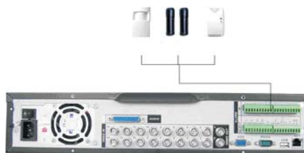
Entrada de alarme
