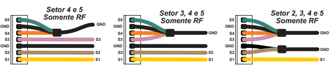
Esquema de ligação sensores infravermelhos em série.
